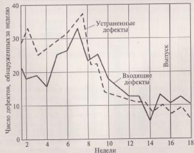
Рис. 5.10. Обнаружение дефектов и их устранение с течением времени
